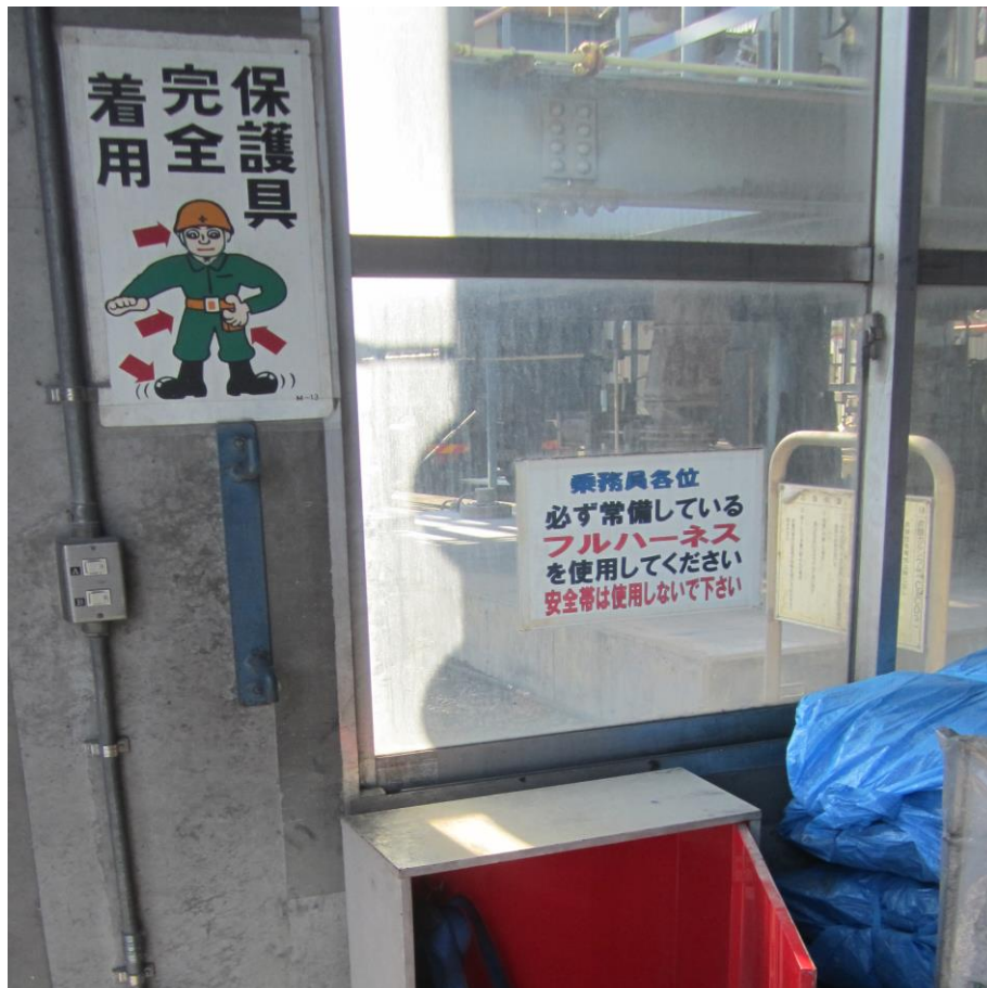
写真6 (ハーネス型安全帯(フルハーネス)の収納箱、表示のように(普通の)安全帯の使用を禁じている)
